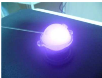
Рис. 2. Фото равномерного рассеяния ЛИ длиной волны 1064 нм, доставленного по световоду в полость, заполненную эмульсией интралипида концентрацией 0,24%
