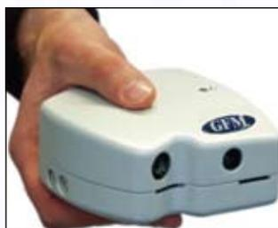
Система PRIMOS pico предназначена для измерения шероховатости, микрорельефа кожи, размеров и объема морщин, рубцов и ран, пор, акне, невусов, нейрофибром и других кожных образований.
